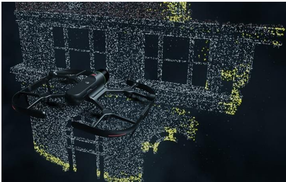
Рис. 6.2. Візуалізація роботи БПЛА з модулем RTK та LiDAR
